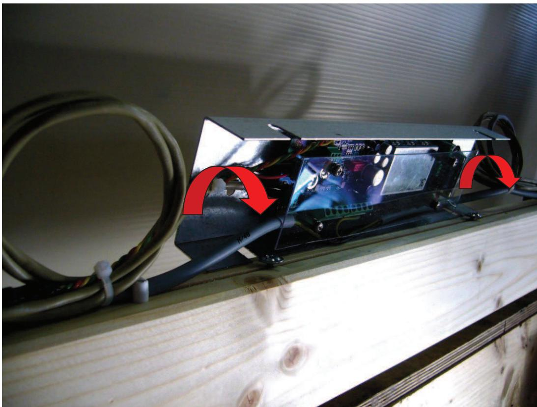
Skivekontaktene er også tilkoblet skiveelektronikken. Den venstre kontakten (hannkontakten) er tilkoblet JP1 terminalblokken, mens den høyre kontakten (hunnkontakten) er tilkoblet JP2 terminalblokken. Sjekk skivekontakte og skivekabler ved kommunikasjonsproblemer i grav.
